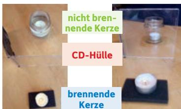
Der Trick ist eine **CD-Hülle**. Hinter ihr steht ein Glas, in dem sich eine **nicht brennende Kerze** befindet. Vor der durchsichtigen Scheibe steht in genau gleichem Abstand eine **brennende Kerze**. Du siehst durch die Plasticscheibe das Glas mit der Kerze und das Spiegelbild der Kerze mit der Flamme übereinander. So scheint die Kerze im Glas zu brennen, tut sie aber nicht. Auf eine nicht brennende Kerze lässt sich natürlich leicht Wasser gießen.
