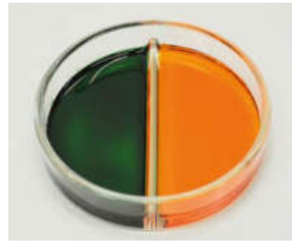
2b | pH-Wert-Messung mit Bromthymolblaulösung bei der Bromierung von Heptan
