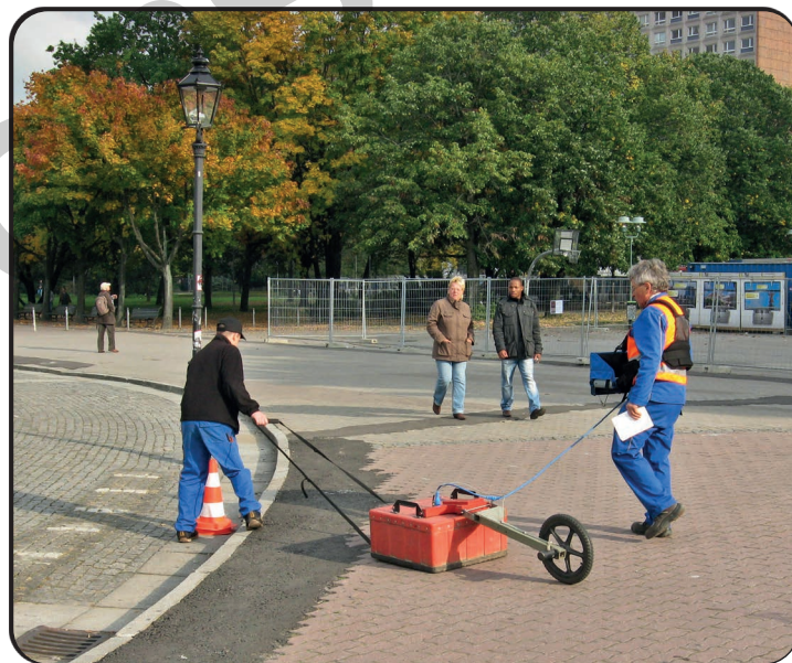
Einsatz von Bodenradar für archäologische Messungen, beim Neptunbrunnen, Marienkirche, Berlin-Mitte
